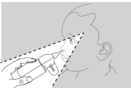
Uygulama sırasında cihazı yüz ile  $20^{\circ}$  ile  $60^{\circ}$  bir açıda tutun.
