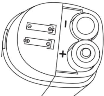
3. Rimontare il coperchio del vano batterie finché non scatta in posizione.
