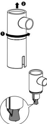
4. Verificare che il gruppo vaporizzatore sia fissato alla parte superiore dell'ampolla.
