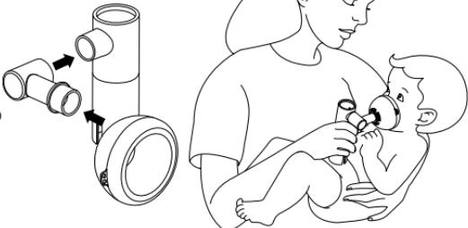
8. Подсоедините воздуховодную трубку. Слегка нажимая и проворачивая штекер воздуховодной трубы, плотно вставьте его в разъем воздуховодной трубы.
