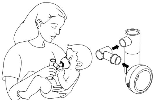
٨. قم بتوصيل خرطوم الهواء. أثناء لقابس خرطوم الهواء قليلاً، ادفعه بإحكام ناحية موصل أنبوب الهواء.
